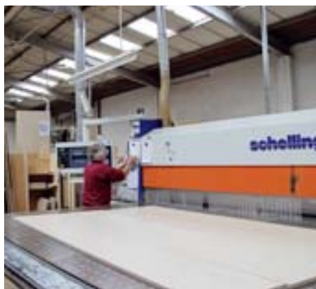
Fertigung und Verwaltung sollen schlank gehalten werden. Eine liegende Plattensäge, ...
